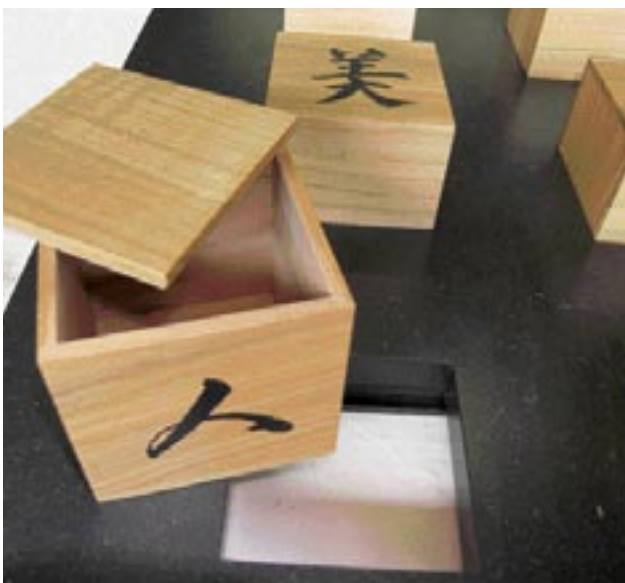
Die sehr präzisen Behälter aus Kirschbaumholz passen spielfrei in die Ausschnitte der Grundplatte.
